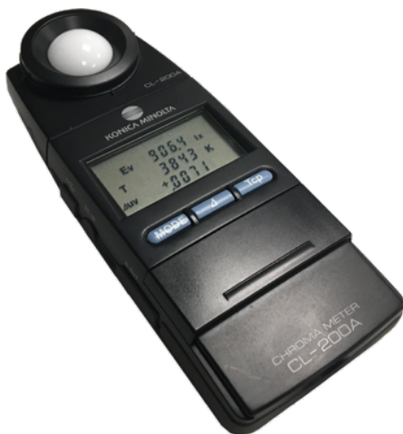
Abbildung 5: Beleuchtungsstärke-Messgerät von Minolta
