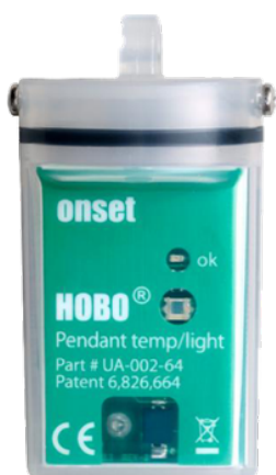
Abbildung 8: Beleuchtungsstärke-Logger Hobo Onset UA-002-64
