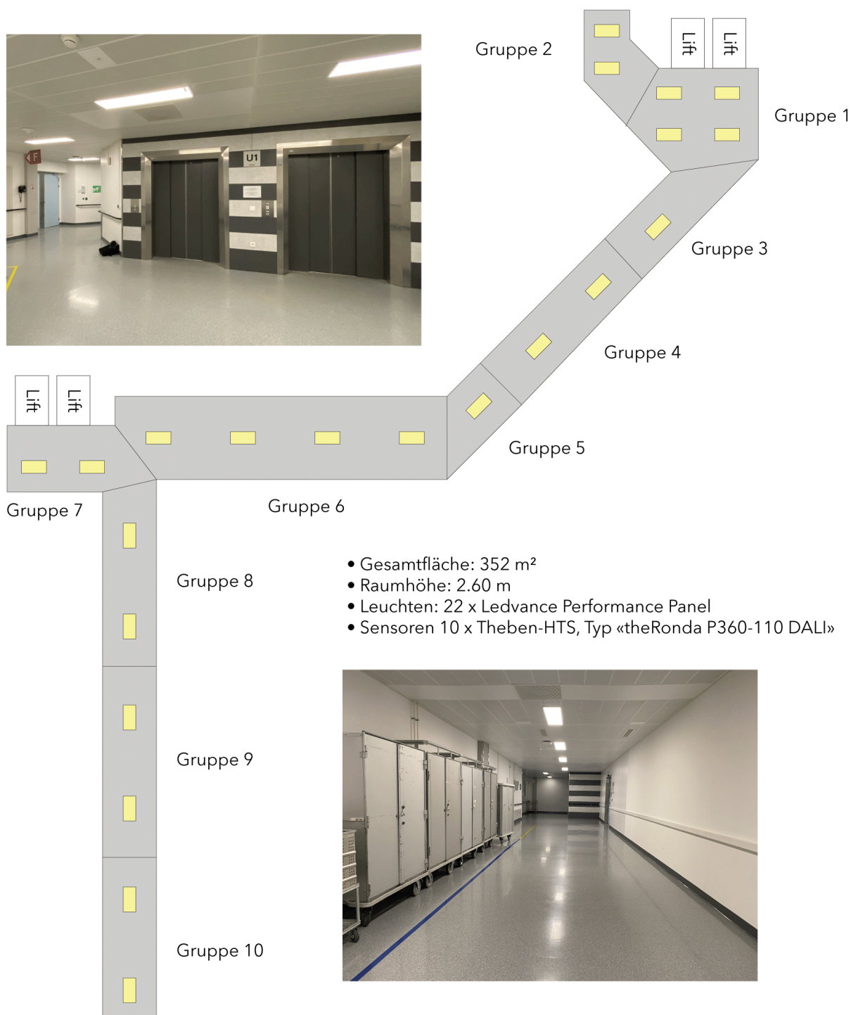
Abbildung 19: neue Korridorbeleuchtung mit 10 Lichtgruppen
