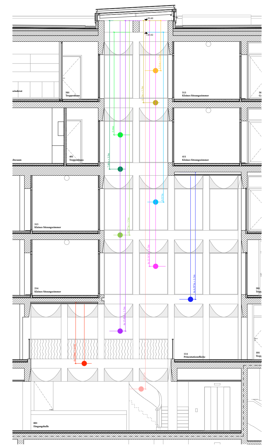
Vertikalschnitt Lichthof m. Längenangaben der Pendel
