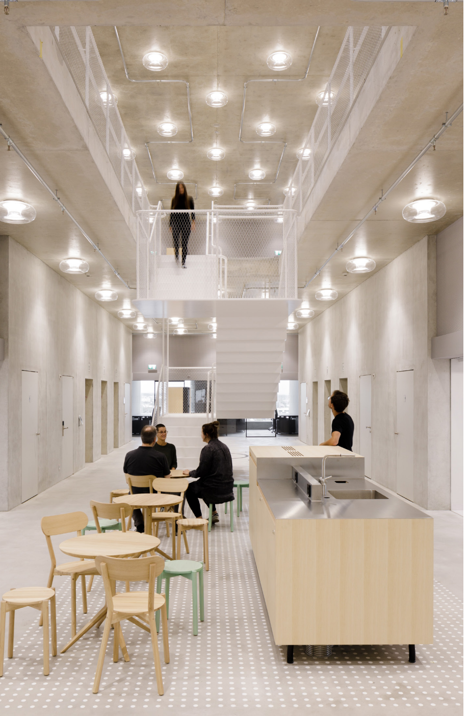
Abb. 10: In den Mittelzonen der jeweiligen Etagen, wo Sozial-, Besprechungs- und Seminarbereiche verortet sind, sorgen Deckenaufbauleuchten für eine homogene und symmetrische Beleuchtung der offen gestalteten Raumstrukturen.
