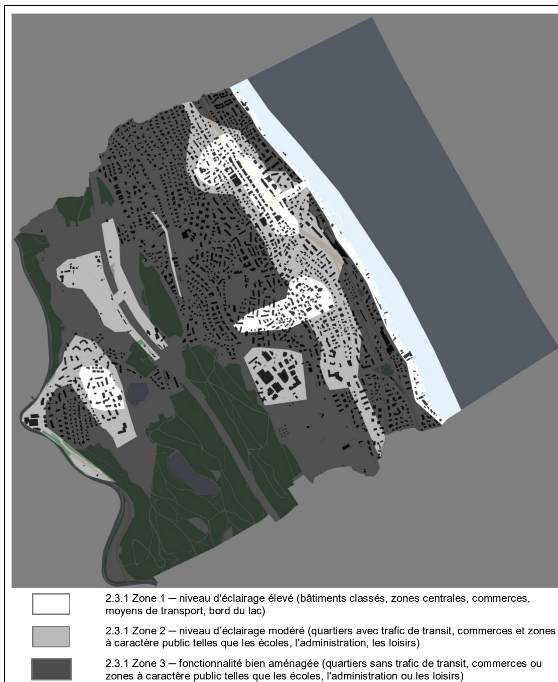
Figure 17 : Exemple de représentation graphique montrant quels aménagements lumineux sont prévus dans quelles zones de la commune (source : Commune de Thalwil 2015).
