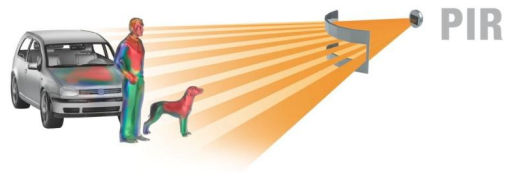
Figura 11: rilevazione sensore a infrarossi passivi (PIR)
