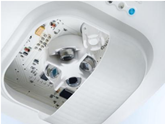
Figura 14: interno di un sensore PIR: sono visibili quattro elementi piroelettrici e la tipica struttura della lente
