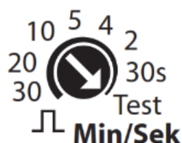
Figura 31: potenziometro per l'impostazione del ritardo di spegnimento
