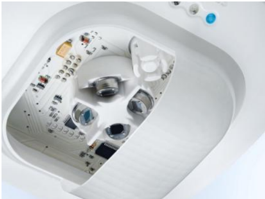
Graphique 14: Aperçu d'un capteur PIR : on peut voir quatre pyrocapteurs et la structure typique des lentilles
