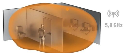
Abbildung 17: Hochfrequenz erfasst sogar durch dünne Wände hindurch
